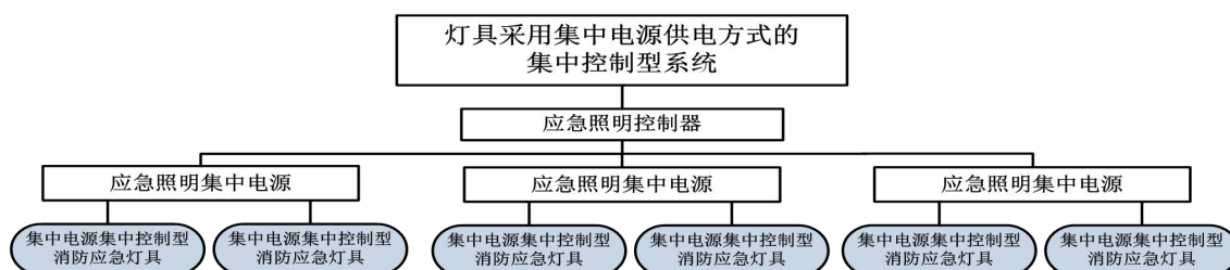
图 2 灯具采用集中电源供电方式的集中控制型系统
